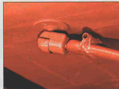
Uchycení vzpěry na křídlo kulovým kloubem. Miska kloubu je na závit a dovoluje nastavit délku vzpěry
