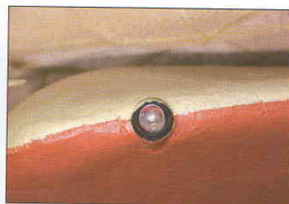
Polohové světlo z LED v pouzdru. Napětí je sníženo předřazeným odporem
