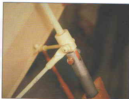
Dolní uchycení nosníku podvozku, výkyvný kloub pružící nohy
