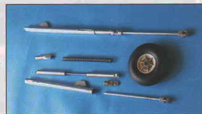
Díly odpružení a tlumení podvozku s pneumatickou pružinou a vodící trubkou
