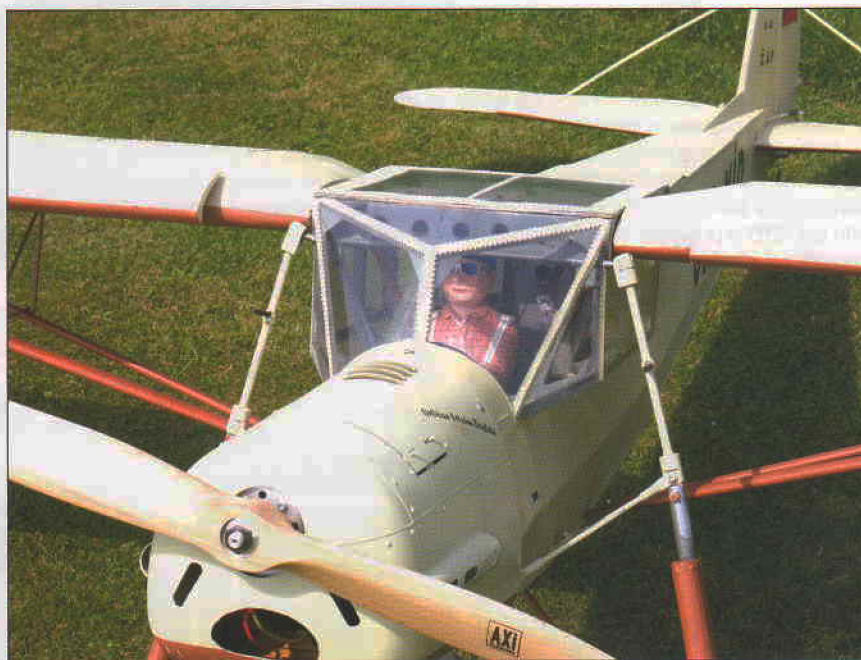
Kabina s uchycovacím kozlíkem, kyvným uzlem a kloubem podvozkové nohy
