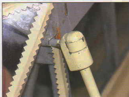
Horní uchycení nosníku podvozku
