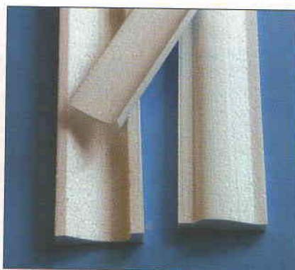
Výřezané jádro slotu a protikusy užívané pro tvarování potahové dýhy
